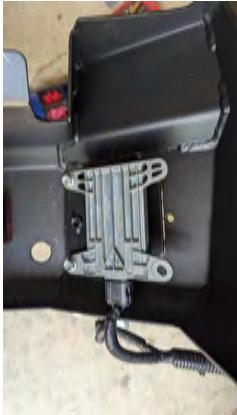
. Démonter les capteurs de stationnement et autre caméras de votre ancien pare chocs en repérant bien leur place (intérieur droit, extérieur gauche , etc ). découper les caches et présenter les capteurs sur les nouveau Pc. Des adaptations peuvent être nécessaire .
