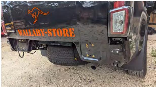
. Démonter le pare choc arrière , les gardes boues, plaque de protections ,attelage et tout ce qui pourrait gêner la pose du nouveau pare choc conformément au préconisations constructeurs.
