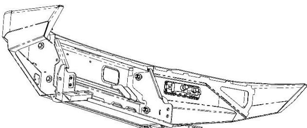
16. A deux personnes, soulevez soigneusement le pare-chocs sur les supports de châssis et fixez-le sans serrer en place. Ajuster les jeux , puis serrez toutes les fixations au couple approprié.
