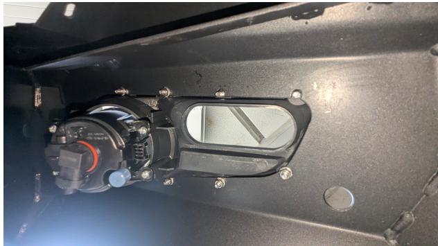
15. Monter les ensembles clignotants/feux antibrouillards/ feux auxiliaires au pare choc.
