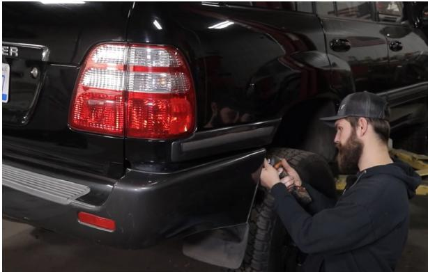
1. La première étape consistera à retirer le pare-chocs arrière d'origine. Il y aura quelques vis dans chaque passage de roue et 4 ou 5 au bas du pare-chocs le long de l'arrière. Une fois ceux-ci retirés, il ne restera plus que quelques clips retenant les ailes au corps. Tirez les ailes sur le côté au niveau du passage de roue pour faire apparaître ces clips. Retirez le pare-chocs.
